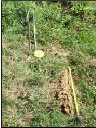
Matériels utilisés pour les relevés de terrain : GPS LE 500, mètre, décimètre et tarière.
